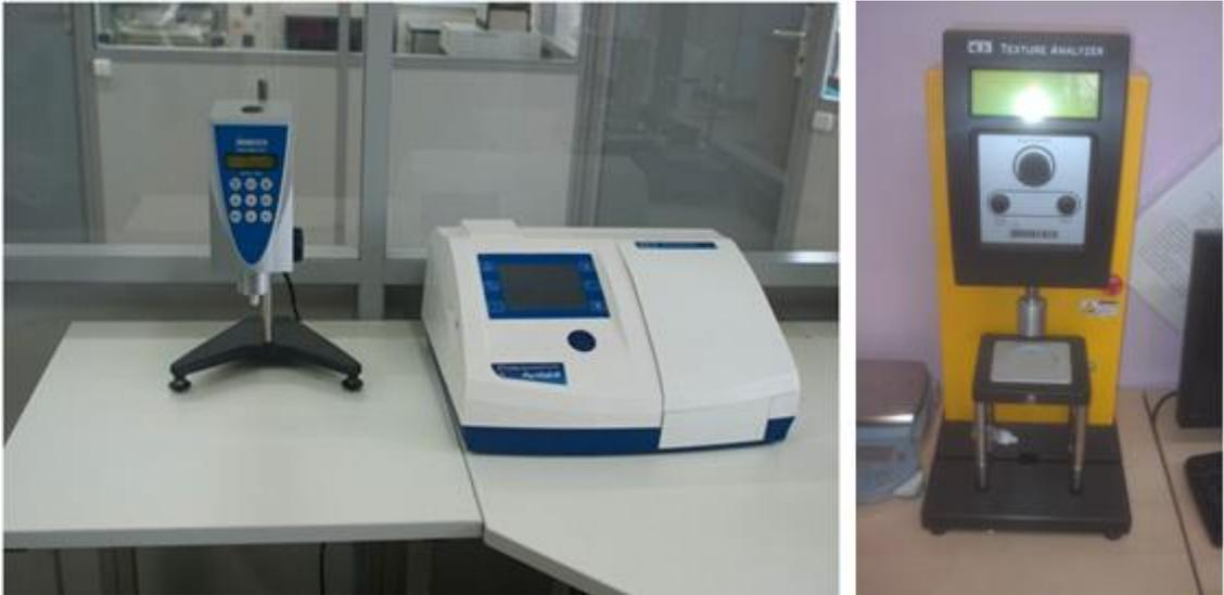
**Рисунок Б.3.** Производственная лаборатория по оценке качества гидрогелевых дисков (вязкостные свойства, концентрация ЛП в диске, прочностные свойства дисков).
