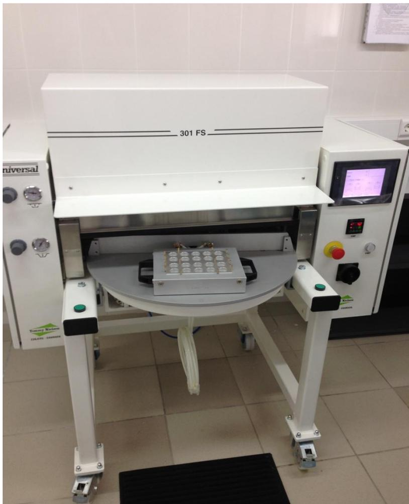
**Рисунок Б.4.** Вакуум-формовочная машина Universal FS301 для формования блистерной упаковки и запайки гидрогелевых дисков.
