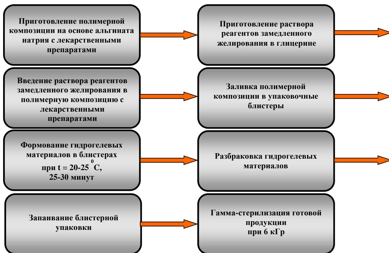
**Рисунок 52.** Схема технологического процесса создания гидрогелевых дисков.
