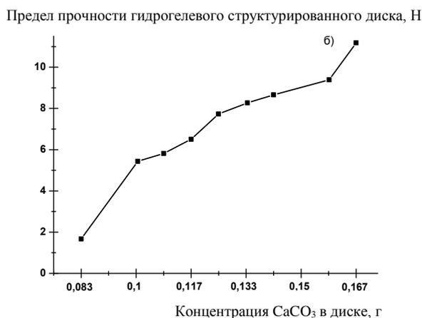
**Рисунок 31.** Влияние концентрации Ca<sup>2+</sup> в гидрогелевой композиции на предел прочности структурированных дисков.
