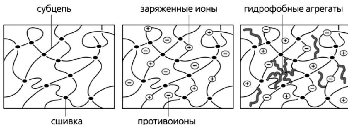
**Рисунок 1.** Схема строения трех форм полимерного геля. Слева направо: незаряженная сетка, полиэлектролитная (в ней за счет диссоциации ионогенных групп в водной среде образуются заряженные звенья на полимерных цепях и низкомолекулярные противоионы) и сетка с гидрофобными группами, ассоциирующими друг с другом в водном растворе [21].
