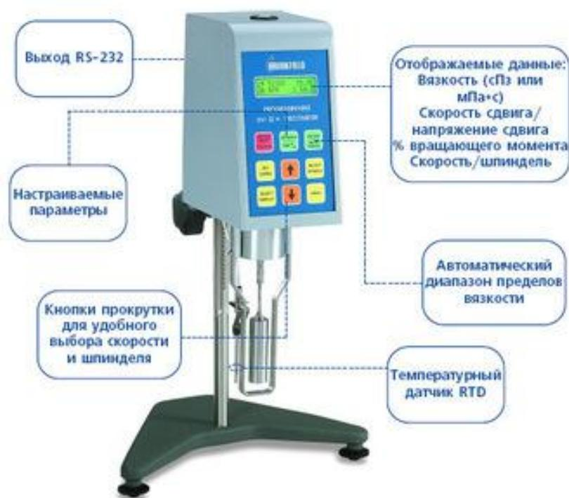
**Рисунок 3.** Ротационный вискозиметр «Brookfield RVDV-II+»
