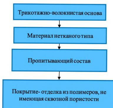
Рисунок 3.3 — Структура полимерных композиций
