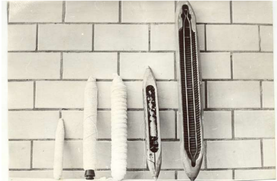
Рис. 3.5 Челноки и трубчатые початки больших габаритов
