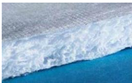
Рисунок 1.3.4 Структура нетканого утеплителя Тинсулейт
