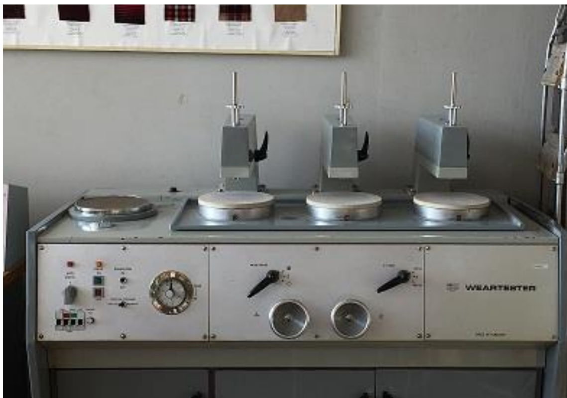
Рисунок 4.2 – Внешний вид прибора «Вертестер»
