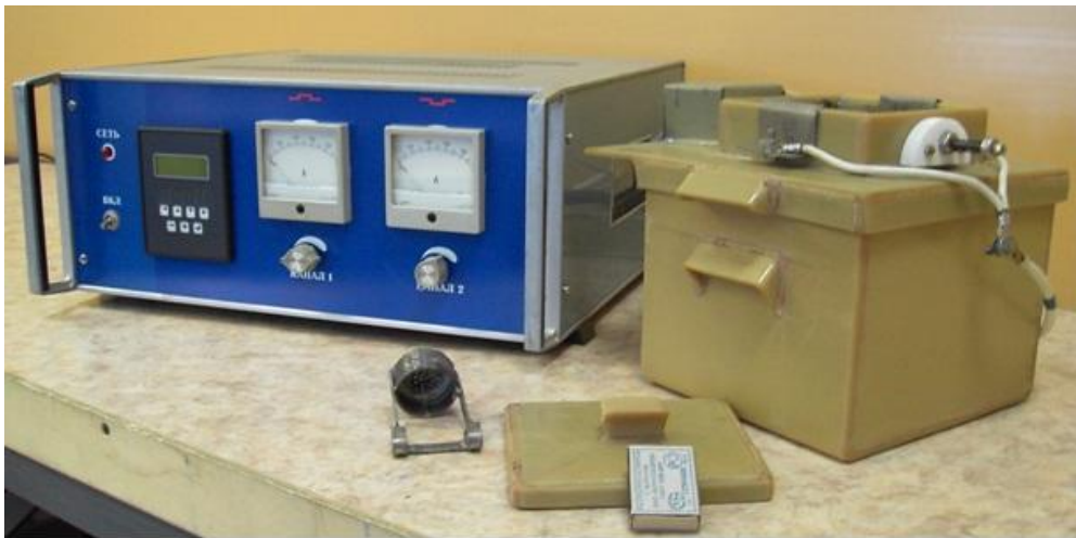
Рис. 58. Цифровые установки для осуществления процесса ЭХФ и ЭХФКП импульсными биполярными токами [61]: a – на 200 А в импульсе и 100 А среднего тока; б – на 20 А в импульсе и 10 А среднего тока
