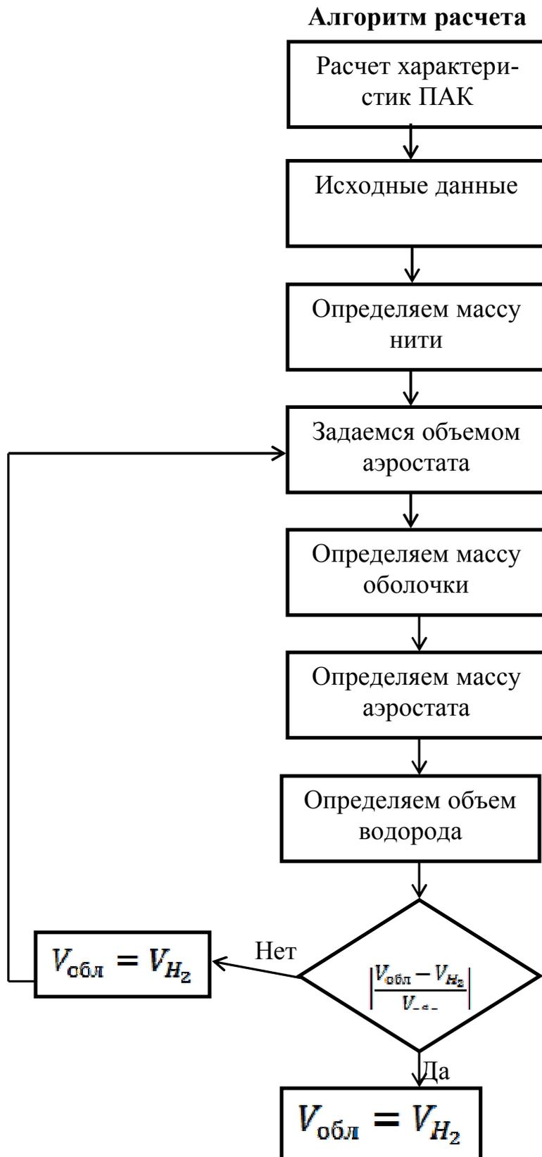
Рис. 2. Алгоритм расчета характеристик ПАК
