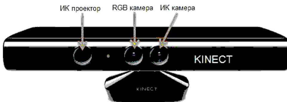
**Рис. 1. Внешний вид камеры Microsoft Kinect v1**
