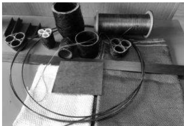
Рис. 3. Все изделия (кроме тканей), представленные на рисунке, изготовлены в лабораторных условиях на основании патентов ООО «ПРОГРЕСИ» 2002-2007 гг. в г.Тбилиси (под руководством Джони Гигнейшвили и Юза Мгалоблишвили). На фото катушка с непрерывным базальтовым волокном и ткани из стекла и базальтового волокна, изготовленные в 1992 году в г. Киеве
