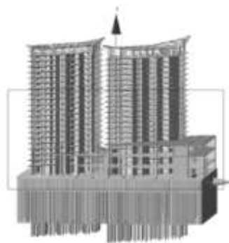
Рис. 3. Полная пространственная компьютерная расчетная модель второго (предложенного нами) варианта гостиничного комплекса «HILTON» в г. Батуми
