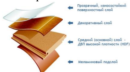
Рис. 4. Составные части ламинированных полов
