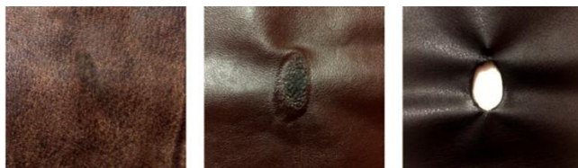
Рисунок 1 – Определение термостойкости разных видов кожи.
