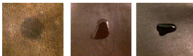
Рисунок 3 – Определение водостойкости разных видов кожи.
