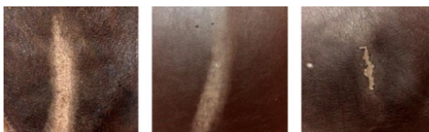
Рисунок 2 – Определение истираемости разных видов кожи.
