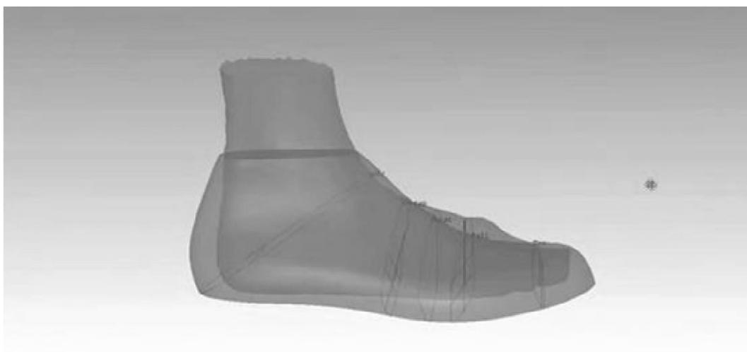
**Рис. 1. Стопа, вписанная в колодку в полупрозрачном режиме отображения**
