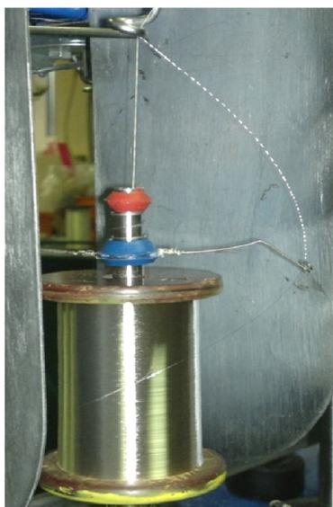
**Рис. 1. Вид баллонирующей медной проволоки при оплетении арамидной нити**
