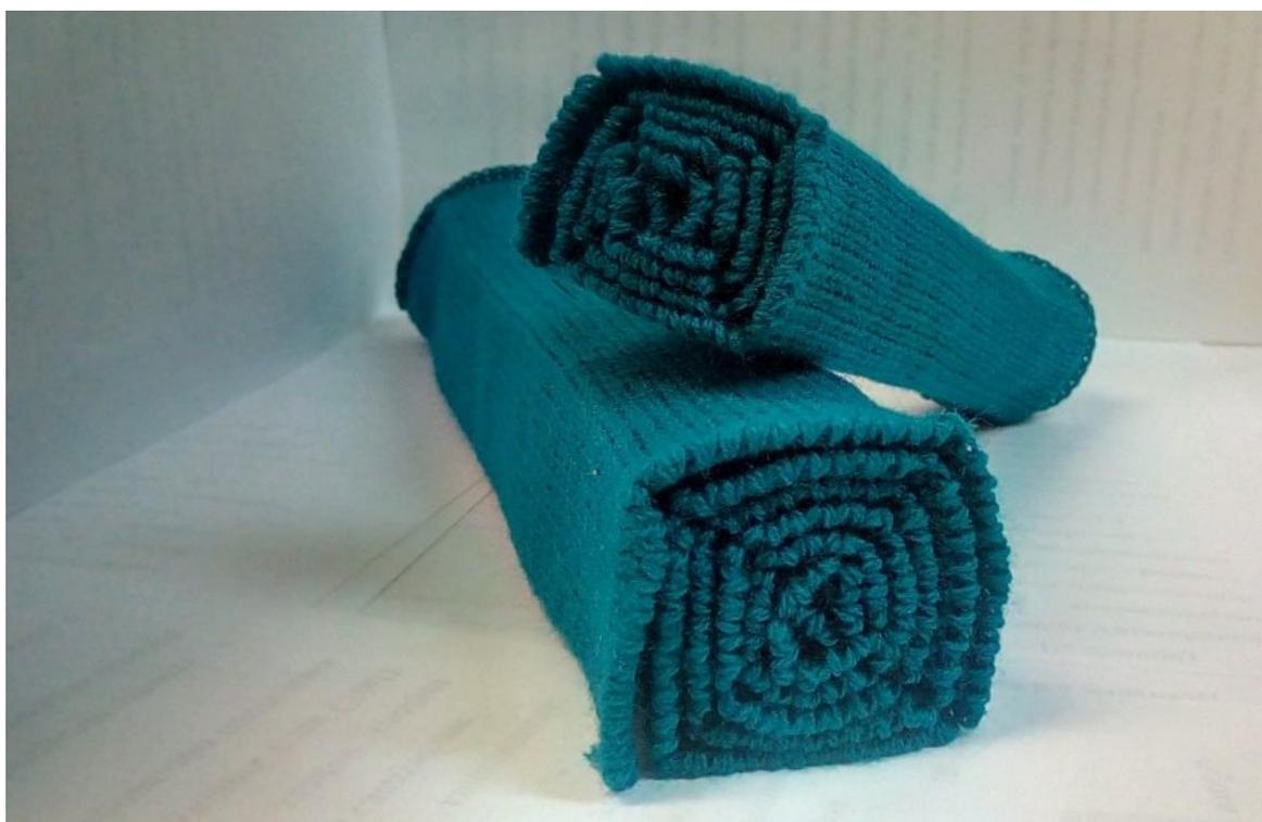
**Рис. 2. Фотография образца объемнозаполненного трикотажа**
