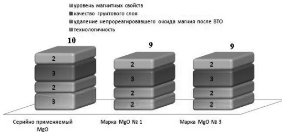
Рис. 2. Интегральный параметр качества готовой электротехнической анизотропной стали (ЭАС), полученный по итогам промышленных испытаний оксида магния опытных марок № 1 и № 3 после корректировки
