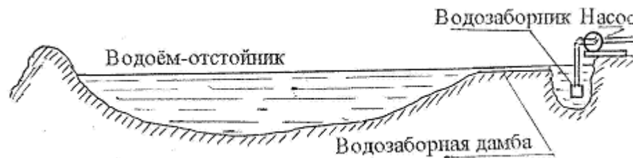
Рис. 2. Принципиальная схема отбора теплого слоя воды с поверхности илоотстойника
