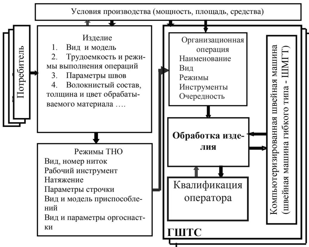
Рис. 2. Процесс определения технологических параметров ГШТС
