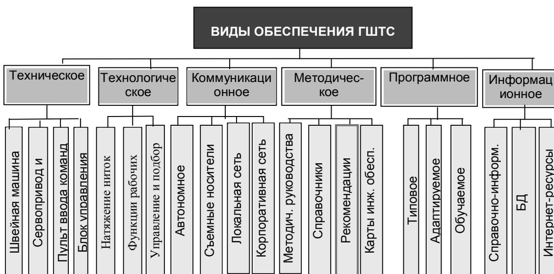
Рис. 3. Виды обеспечений гибкой швейной технологической системы ГШТС
