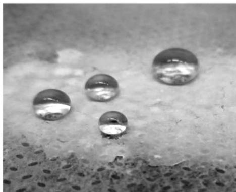
**Рис. 2. Капли воды на поверхности нановолокнистого материала**
