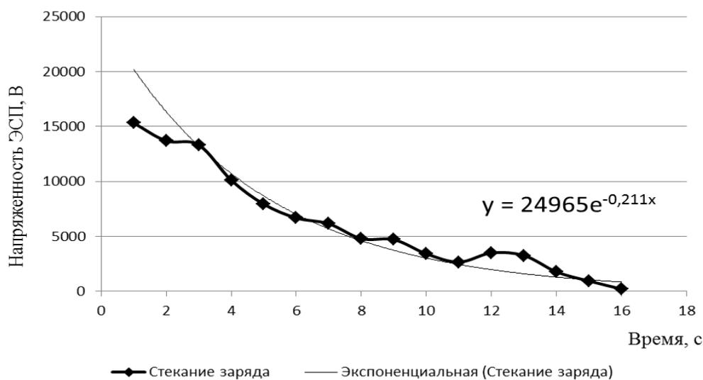
**Рис. 2. Зависимость напряженности ЭСП отрезка времени, с построением экспоненциальной линии**
