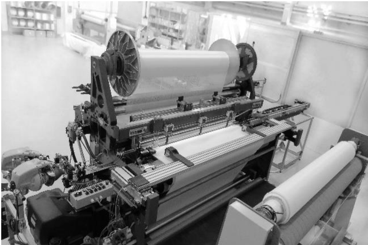
Рис. 1. Ткацкий станок DIFA для 3D объемных тканей
