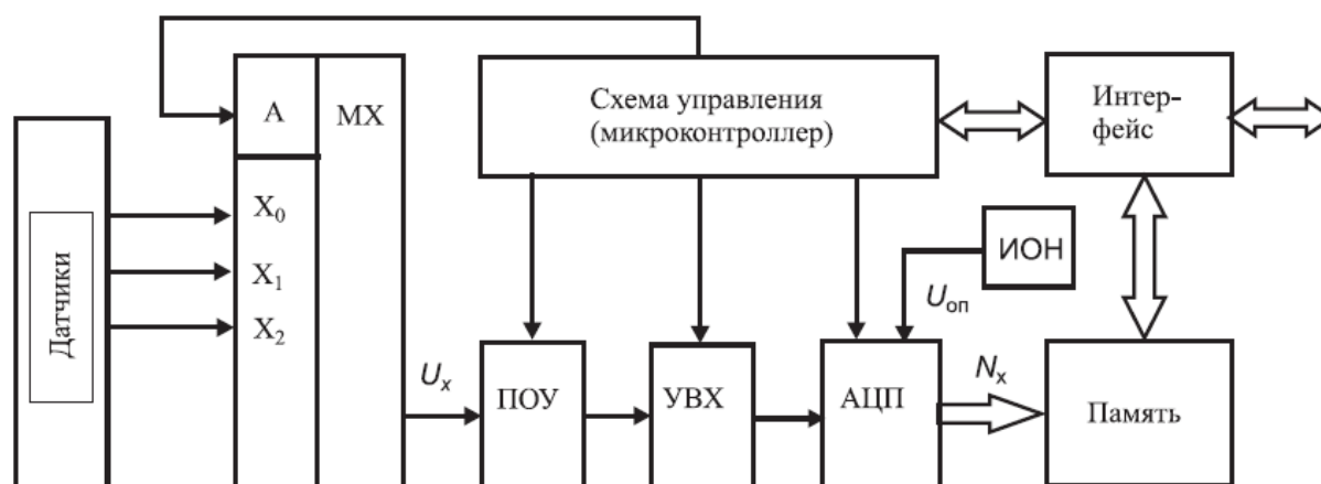
Рис. 2. Структурная схема измерительных преобразователей
