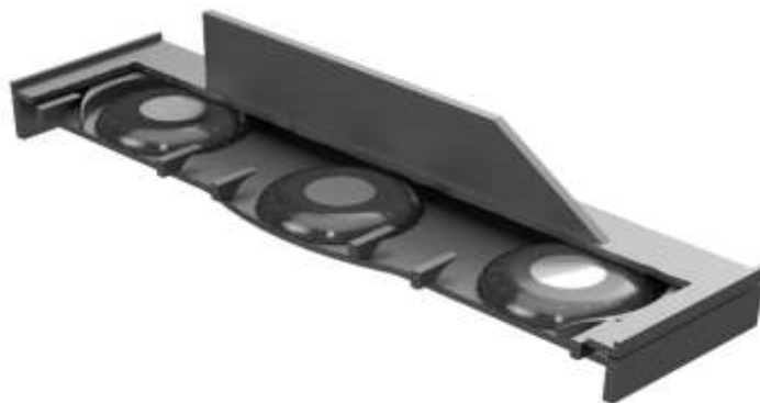
Рис. 2. Шпарутка ткацкой машины с тремя игольчатыми дисками
